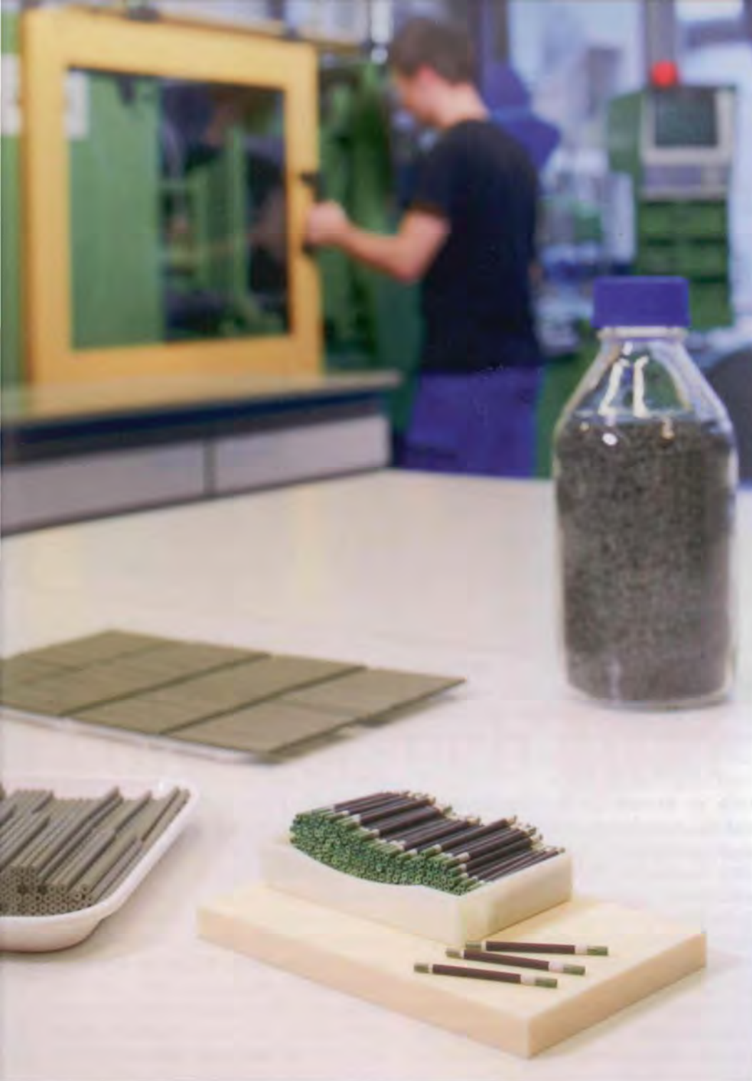
Klein, aber oho: Die Gasbatterie für Laptop, Handy oder E-Bike basiert auf einer mikrotubularen SOFC. Sie besteht aus kleinen Keramikröhrchen (Bild), die die eigentlichen Zellen sind.
