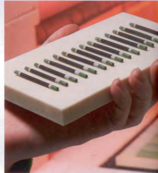
Klein, aber oho: Die Gasbatterie für Laptop, Handy oder E-Bike basiert auf einer mikrotubularen SOFC. Sie besteht aus kleinen Keramikröhrchen (Bild), die die eigentlichen Zellen sind.
